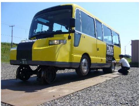
運行前にJR運転士による運行前点検。車輪の出し入れの点検。(レールが出た状態)
